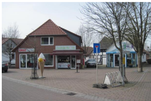
Höhengleiche Profile und homogenes Material lassen Fahrbahn und Seitenräume optisch zusammenwachsen.
